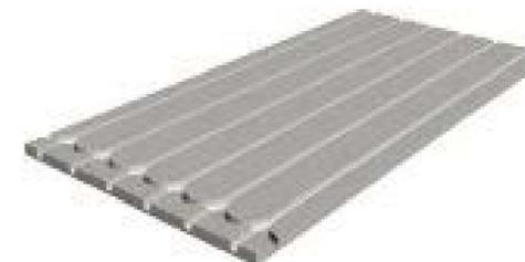
La soluzione con lastra superficiale fresata consente di distribuire il tubo multistrato o in polietilene all'interno della fresatura per ottenere un riscaldamento e raffreddamento a pavimento con caratteristiche di bassissima inerzia termica e conseguente risparmio energetico.
