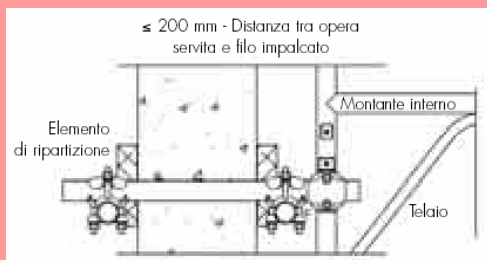
Esempio di ancoraggio "a cravatta"
